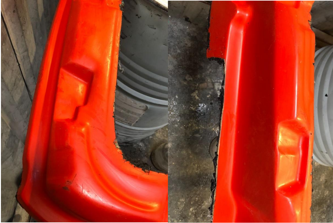
Ilustración 32. Refuerzos del cofre KW T-680, VH527 libre de sarro. Fuente: CVNS Industrias SA de CV, 2022.
