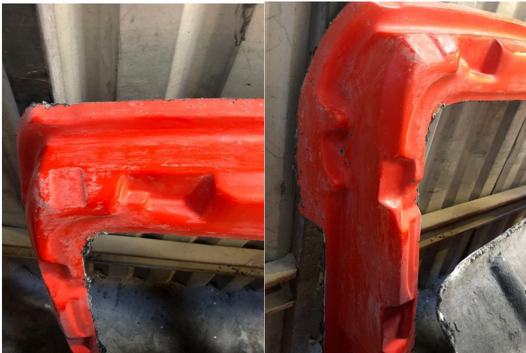
Ilustración 22. Molde del cofre VH 527 con exceso de sarro. Fuente: CVNS Industrias SA de CV, 2022.
